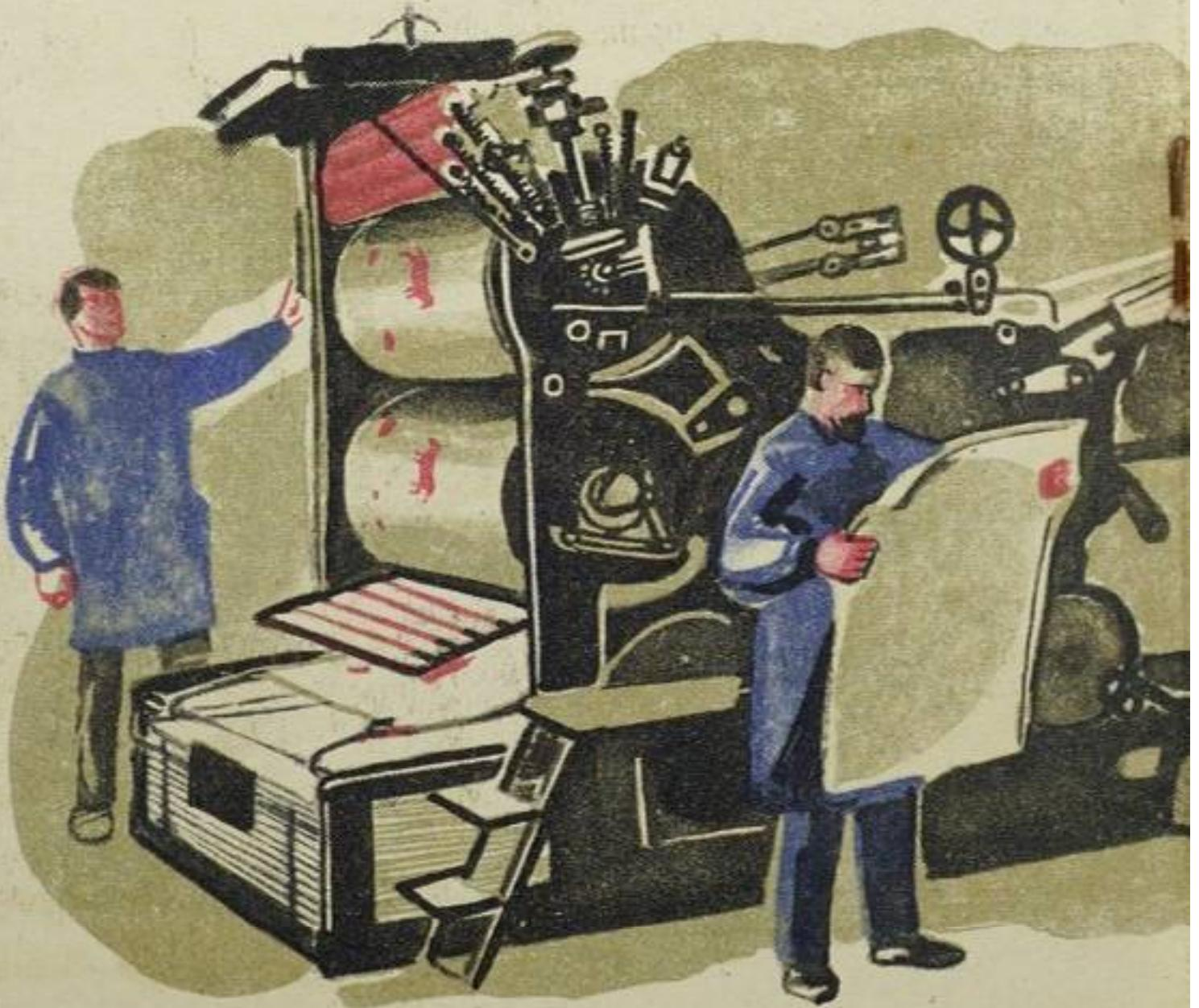
Цинковый лист прикрепили на круглый вал машины (машина «оффсет»). Верхние валики растирают краску. С них краска переходит на цинковый вал. С цинкового вала на резиновый, а с резинового краска переходит на бумагу. Сколько красок на рисунке, столько раз лист бумаги пропускается через машину.
