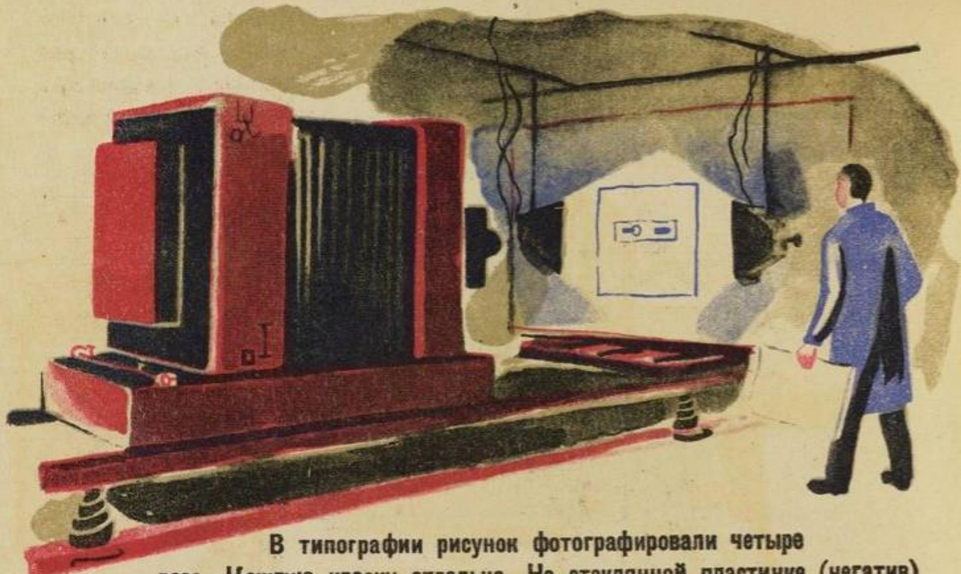
В типографии рисунок фотографировали четыре раза. Каждую краску отдельно. На стеклянной пластинке (негатив) темные места вышли светлыми и даже прозрачными, а светлые — темными.
