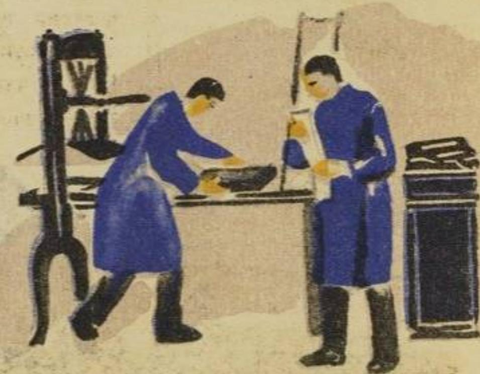
Слова (текст) набрали по буквам отлитыми из металла. Готовый набор и рисунок с камня отпечатали на переводную бумагу. Бумагу разрезали, рисунок прикрепили на папку в том порядке, как должна быть напечатана книга.
